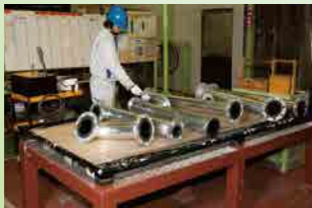
●PELライニング完成検査
